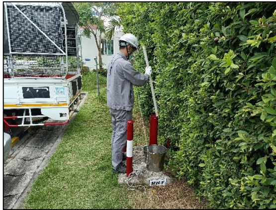
รูปที่ 3.11 การเก็บตัวอย่างคุณภาพน้ำใต้ดิน บริเวณ ด้านหน้าโรงงาน
