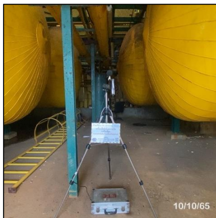
รูปที่ 3.25 การตรวจวัดระดับเสียงในพื้นที่ทำงาน บริเวณ หน่วยผลิตคลอรีนเหลว
