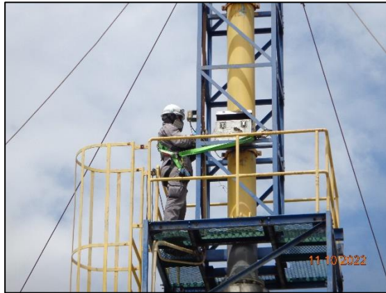
รูปที่ 3.4 การเก็บตัวอย่างคุณภาพอากาศในปล่องระบาย บริเวณ หอดูดซับไฮโดรคลอรีน
