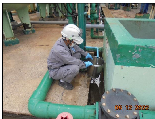
รูปที่ 3.8 การเก็บตัวอย่างคุณภาพน้ำทิ้ง บริเวณ จุด Effluent
