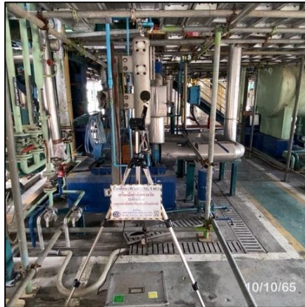
รูปที่ 3.23 การตรวจวัดระดับเสียงในพื้นที่ทำงาน บริเวณ หน่วยเพิ่มความเข้มข้น NaOH
