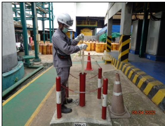
รูปที่ 3.12 การเก็บตัวอย่างคุณภาพน้ำใต้ดิน บริเวณ ด้านข้างลานถังเก็บผลิตภัณฑ์
