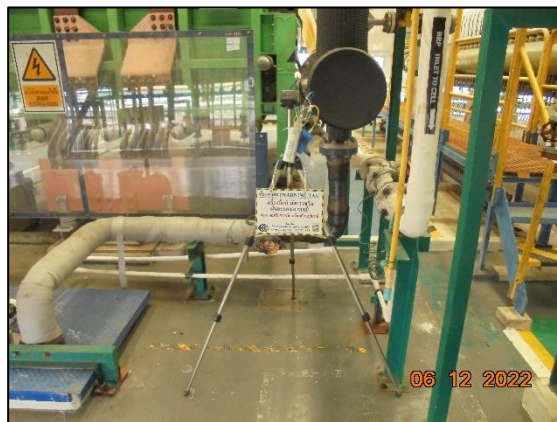
รูปที่ 3.21 การตรวจวัดคุณภาพอากาศในพื้นที่ทำงาน บริเวณ ห้อง Cell room MTA 7- 8
