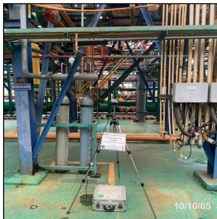
รูปที่ 3.24 การตรวจวัดระดับเสียงในพื้นที่ทำงาน บริเวณ หน่วยผลิตกรดไฮโดรคลอริก
