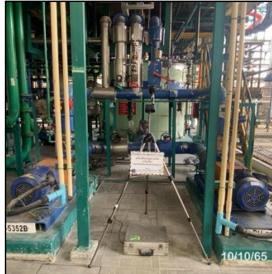
รูปที่ 3.26 การตรวจวัดระดับเสียงในพื้นที่ทำงาน บริเวณ หน่วยผลิต MTA-7
